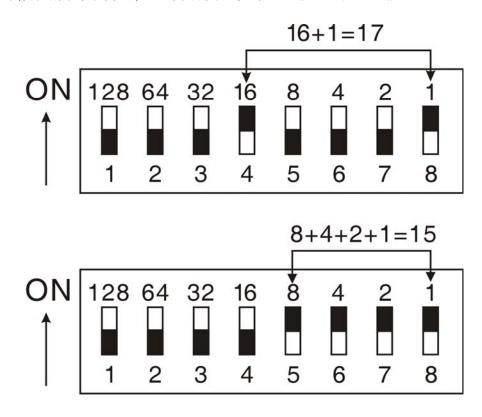
图 (8) 地址码设置总线防区号方法
