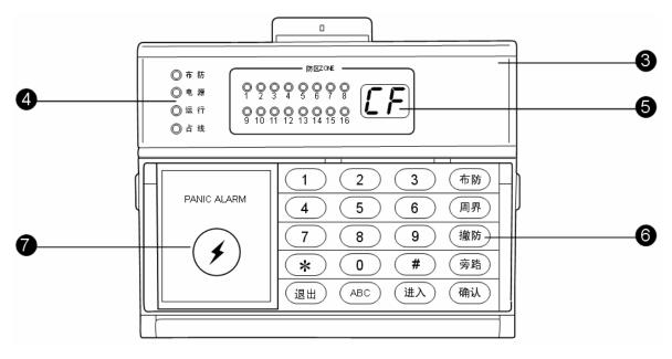
图 (2) LED 显示分体键盘正面
