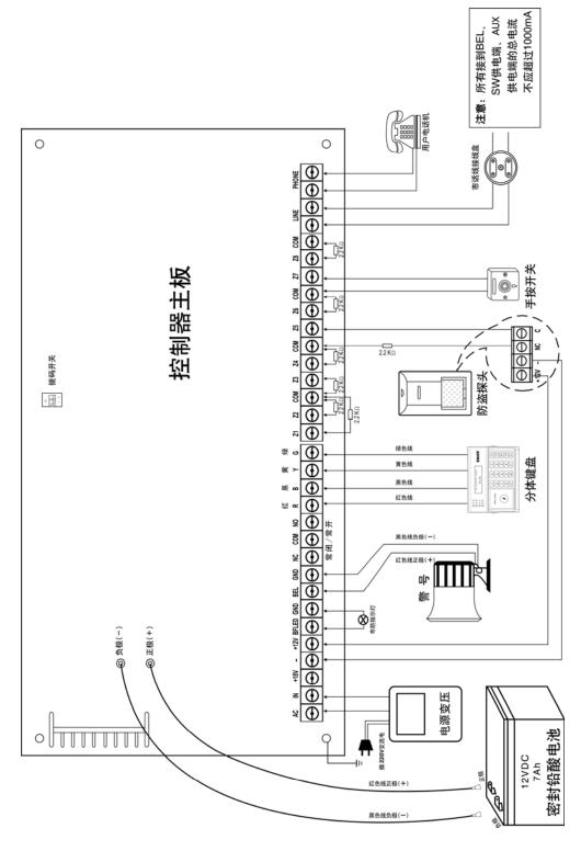
图 (5) 控制器主板接口结构
